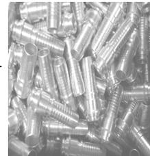
Massendrehteile für die Hydraulikindustrie
